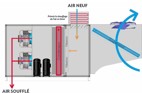
Maintien de la température ambiante en hiver par le cycle chaud (thermodynamique) avec préchauffage de l'air neuf. La chaleur est prélevée de l'air extérieur. Cette chaleur est restituée au condenseur. L'air neuf est préchauffé avant de passer sur le condenseur.
