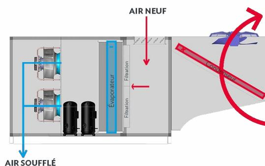
Maintien de la température ambiante en été par le cycle froid (thermodynamique). La chaleur de l'air traité prélevée par l'évaporateur est évacuée par le passage de l'air extérieur au travers du condenseur.
