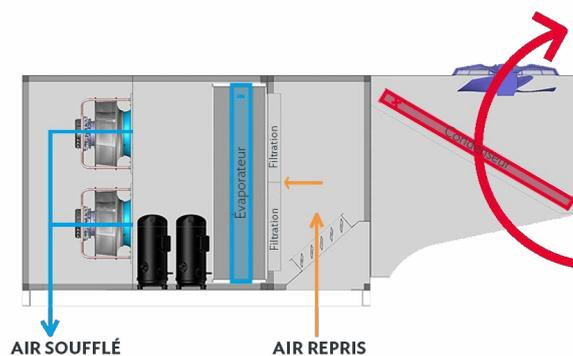
Maintien de la température ambiante en été par le cycle froid (thermodynamique). La chaleur prélevée à l'air passant sur l'évaporateur est évacuée par le passage de l'air extérieur au travers du condenseur. Fonctionnement hors ERP (établissement recevant du public). Pas de volet d'air neuf.
