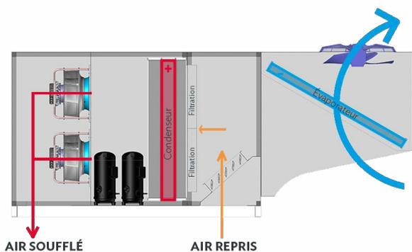
Maintien de la température ambiante en hiver par le cycle chaud (thermodynamique) avec ou sans la possibilité d'ajouter un appoint électrique ou eau chaude en option. La chaleur est prélevée à l'air extérieur passant sur l'évaporateur et est restituée au condenseur qui réchauffe l'air repris.
