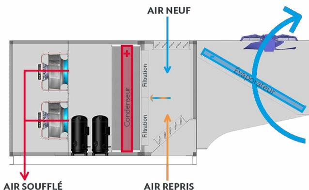
Maintien de la température ambiante en hiver par le cycle chaud (thermodynamique) avec possibilité d'ajouter un appoint ou un préchauffage (électrique/eau chaude) en option.
