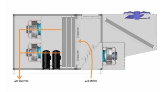
Lorsqu'il n'y a pas de besoin en air neuf hygiénique, que l'ambiance est satisfaisante, mais que la température d'air repris est supérieure à la température d'air ambiant, la machine fonctionne en recyclage et permet ainsi de faire de la déstratification (possibilité de régler la consigne d'écart entre la reprise et l'ambiance).
