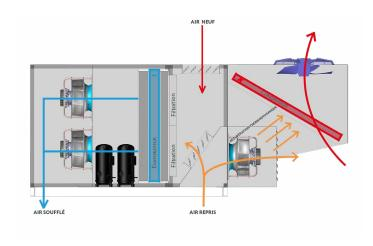
Maintien de la température ambiante en été par le cycle froid (thermodynamique) avec récupération thermodynamique sur la batterie extérieure lors des phases d'extraction (introduction d'air neuf hygiénique).
