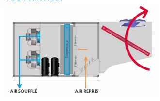
Maintien de la température ambiante en été par le cycle froid (thermodynamique) avec récupération thermodynamique sur la batterie extérieure. Fonctionnement tout air neuf.
