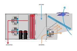
Maintien de la température ambiante en hiver par le cycle chaud (thermodynamique) avec récupération thermodynamique sur la batterie extérieure. Fonctionnement tout air neuf, préchauffage de l'air neuf par la batterie eau chaude de préchauffage (en option) avant le passage de l'air sur le condenseur.
