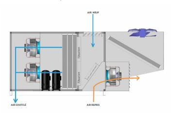
FREE-COOLING: rafraîchissement ou maintien de l'ambiance en mi-saison par l'air neuf extérieur (circuit thermodynamique à l'arrêt), et extraction de l'air intérieur par le ventilateur d'extraction afin de ne pas mettre en surpression le local traité.
