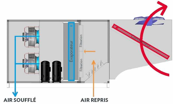
Maintien de la température ambiante en été par le cycle froid (thermodynamique) avec récupération thermodynamique sur la batterie extérieure. Fonctionnement tout air neuf.
