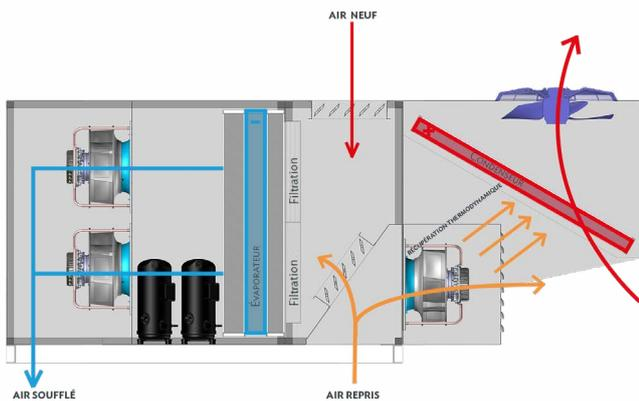
Maintien de la température ambiante en été par le cycle froid (thermodynamique) avec récupération thermodynamique sur la batterie extérieure lors des phases d'extraction (introduction d'air neuf hygiénique).
