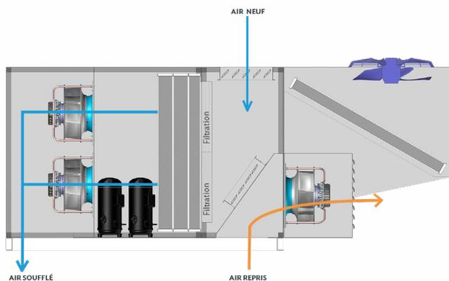
**FREE-COOLING** : rafraîchissement ou maintien de l'ambiance en mi-saison par l'air neuf extérieur (circuit thermodynamique à l'arrêt), et extraction de l'air intérieur par le ventilateur d'extraction afin de ne pas mettre en surpression le local traité.
