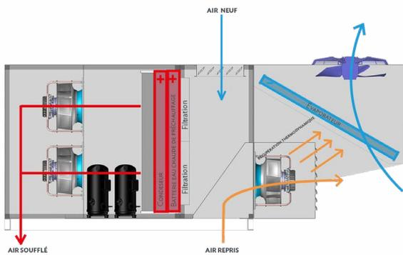
Maintien de la température ambiante en hiver par le cycle chaud (thermodynamique) avec récupération thermodynamique sur la batterie extérieure. Fonctionnement tout air neuf, préchauffage de l'air neuf par la batterie eau chaude de préchauffage (en option) avant le passage de l'air sur le condenseur.
