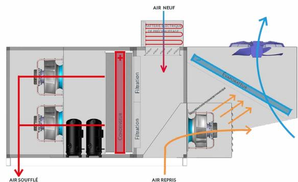
Maintien de la température ambiante en hiver par le cycle chaud (thermodynamique) avec récupération thermodynamique sur la batterie extérieure. Fonctionnement tout air neuf, préchauffage de l'air neuf par les batteries de préchauffage électrique dans un caisson extérieur (option uniquement pour les SMART E de 30 à 85) avant le passage sur le condenseur.
