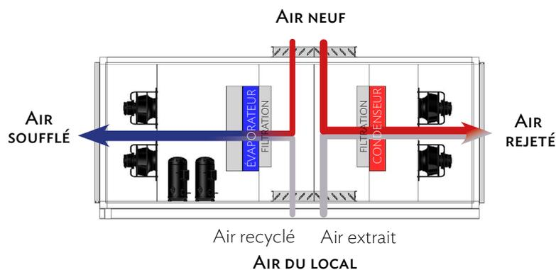
Le système frigorifique à deux compresseurs permettant deux étages de puissance assure le soufflage du mélange air neuf - air extrait recyclé, refroidi selon les besoins. La chaleur prélevée à l'évaporateur (en bleu) est évacuée par le mélange air extérieur - air extrait au passage du condenseur (en rouge).
