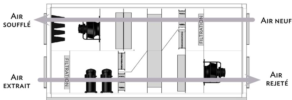
Rafraîchissement gratuit par apport d'air neuf frais en proportion variable du mini jusqu'à 100%. Compresseurs à l'arrêt.
