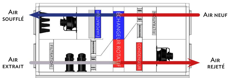
En partie basse, l'air extrait traverse l'échangeur rotatif qui réalise un pré-refroidissement de l'air neuf introduit. Un refroidissement complémentaire est assuré par la thermodynamique permettant ainsi de souffler à température neutre.
