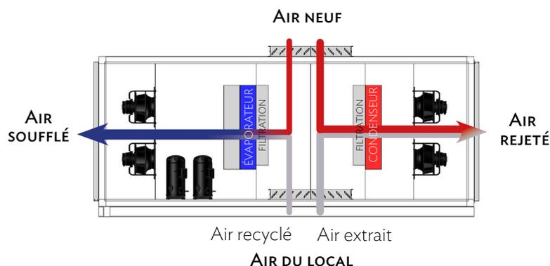
Le système frigorifique à deux compresseurs permettant deux étages de puissance assure le soufflage du mélange air neuf - air extrait recyclé, refroidi selon les besoins. La chaleur prélevée à l'évaporateur (en bleu) est évacuée par le mélange air extérieur - air extrait au passage du condenseur (en rouge).
