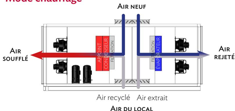
La chaleur est prélevée au mélange air extrait - air extérieur. Cette chaleur est restituée au condenseur qui réchauffe le mélange air neuf et air recyclé. Lors de basses températures, un dégivrage est assuré automatiquement. La récupération de la chaleur de l'air extrait augmente sensiblement le coefficient de performance de la pompe à chaleur et réduit le nombre de dégivrages nécessaires. L'air neuf réduit au minimum l'hygiène.
